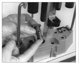
**2** Install the primer punch, spring and primer guide into STATION 2.
